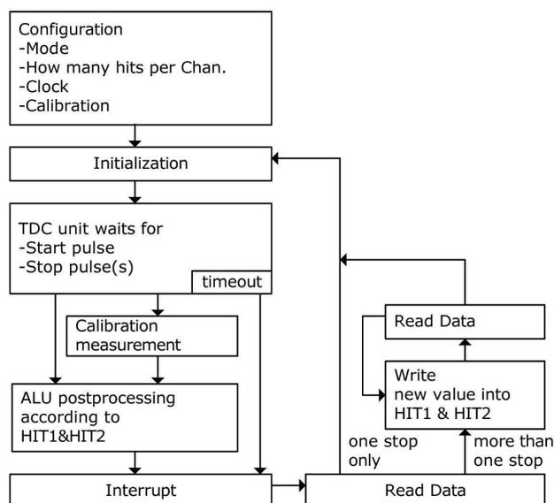
尽管 TDC 单元的每个通道可以测量 4 次，但是用户可以自由定义 ALU 计算哪两个信号之间的时差。可以在寄存器 1 的 Bit16-19 (HIT1) 以及 20-23 (HIT2) 中进行设置。具体设为：
