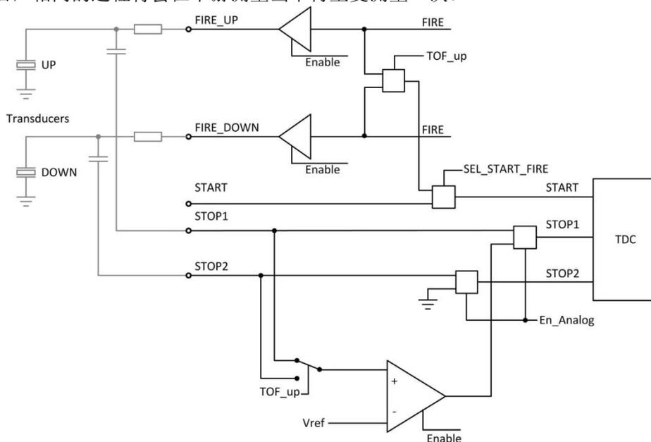
比较器的偏移电压 **offset** 的设置可以以 1mV 为基础进行，从 -8mV 到 +7 mV。这个设置是通过寄存器 6 中参数 **DA\_korrt, Bit 25-28** 进行的，以 2 的补码形式给出。
