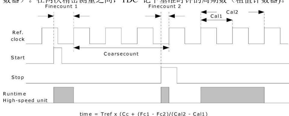
3.6V 和 25° C 时, SL1922 的最小分辨率是 75ps。RMS 噪音大约是 50ps(0.7LSB)。门电路的传播延迟时间主要取决于温度和电压。在测量范围 2 中测量结果是精确测量值和粗略测量值的总和。因此在测量范围 2 中必须进行校准。在校准期间,TDC 分别测量一个和两个基准时钟周期。
