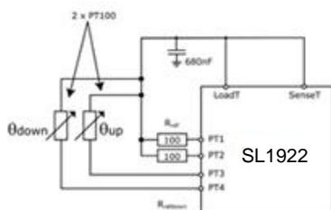
温度测量是完全自动完成的。通过单片机发送操作码 Start\_Temp 或 Start\_Temp\_Restart。发送 Start\_Temp\_Restart，SL1922 将会测量温度两次，两次之间的时间延迟为 50 Hz/60Hz 的倍数。这将会有助于降低 50Hz/60Hz 的噪声。
