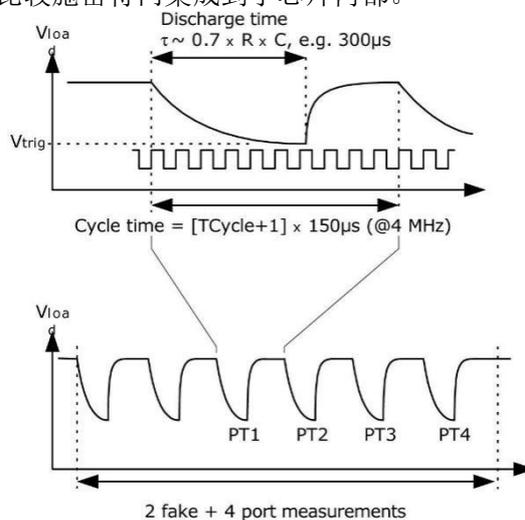
温度测量单元有 4 个电阻测量端口，其中 2 个作为温度传感器测量端口用于热水（上游）和冷水（下游）的测量，另外两个用于连接参考电阻。一般来说只需要连接一个参考电阻到两个端口就可以了。
