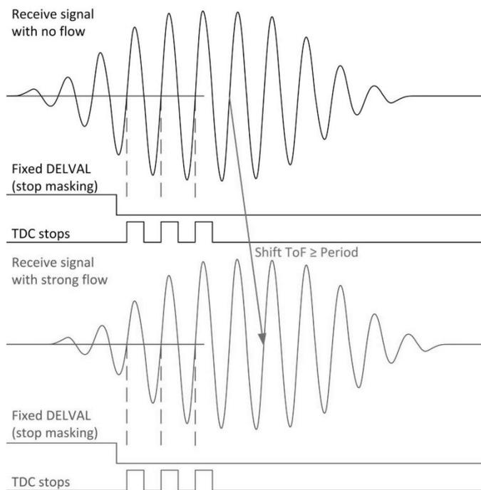
另外还有一种情况可能会获得错误测量。就是在测量换能器上以及在测量反射镜面上或者测量壳体上的覆盖物。这些覆盖物将会导致测量信号的衰减从  $\pm 400\text{ mV}$  到  $< \pm 80\text{ mV}$ 。右图显示了这种问题当仅应用一个固定 offset 的时候来检测第一个回波的时候，将会影响第一个波的识别。一旦第一个波的幅值低于 offset 值的时候，那么测量结果将会跳变一个周期。
