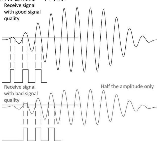
通过 SL1922 的第一波检测功能，芯片的测量的脉冲的时间是相关于第一个回波的时间，而完全与流体温度和流体的速度无关的。因此，一些错误的零点检测以及零点的识别则不再会出现了。
