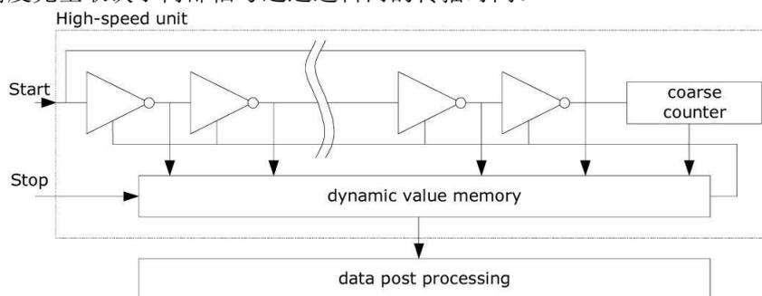
测量单元是通过一个 start 信号触发, stop 信号截止的。由环形振荡器的位置和粗值计计数值可以计算出 START 信号和 STOP 信号之间时间间隔，测量范围可达 20 位。
