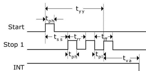
每一个输入端均可被单独设置成上升沿或者下降沿触发有效可通过设置寄存器 0 的 bit0-2(NEG\_START, NEG\_STOP1)选择触发沿。此外所有的 START/STOP 输入端口均支持高电平激活。
