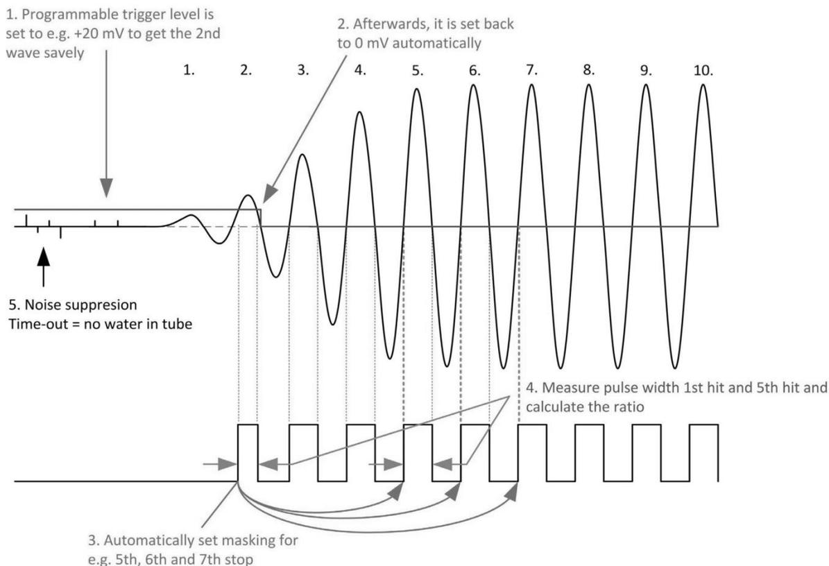
1. 脉冲发生器，将第一波检测所需的比较器的偏移电压 `offset` 设置到一个可编程的水平。
