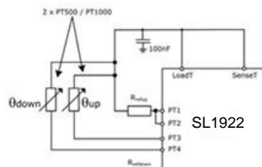
SL1922 同时也支持 PT100 传感器的测量，但是测量的稳定性将会有下降。在这个情况下，我们建议将两个参考电阻全部连接而不是仅仅连接一个电阻。如右图所示。这将有助于通过两点温度较准来补偿温度传感器在整个温度范围的增益偏移。
