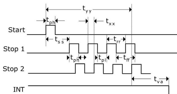
每一个输入端均可以被单独设置成上升沿、下降沿或上下沿同时触发有效。可通过设置寄存器 0 的 bit 8-10 位(EG\_START, NEG\_STOP1, NEG\_STOP2)和寄存器 2 的 bit 27& 28, REFDGEx 来选择触发沿。此外所有的 START/STOP 输入端口均支持高电平激活。
